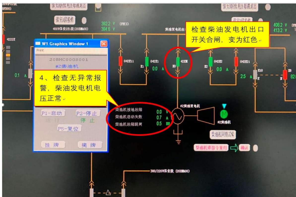
图 2-5 DCS 界面启停柴油发动机步骤四操作图
