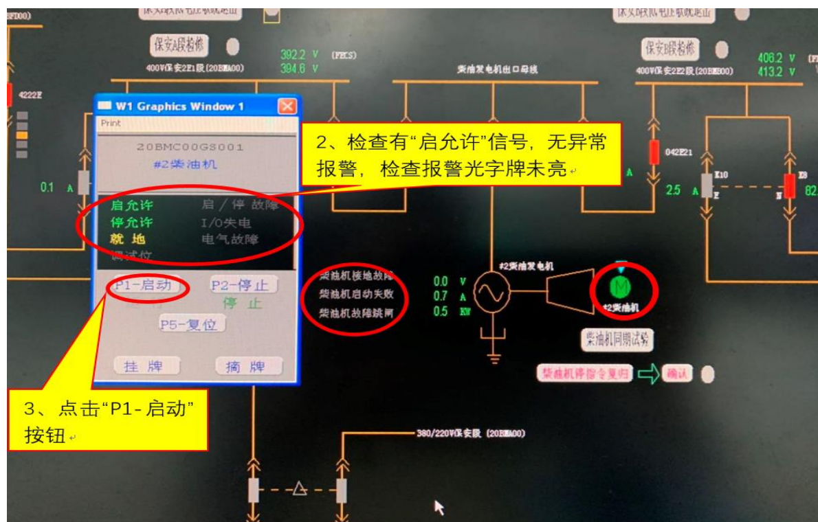
图 2-4 DCS 界面启停柴油发动机步骤三操作图
