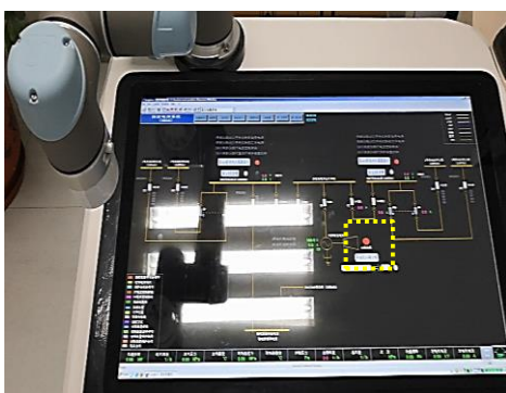
(h) 框中柴油发动机已开启，机械臂回到初始位置
