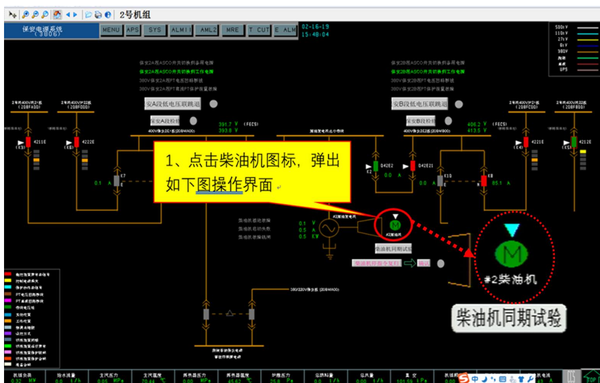
图 2-3 DCS 界面启停柴油发动机步骤二操作图
